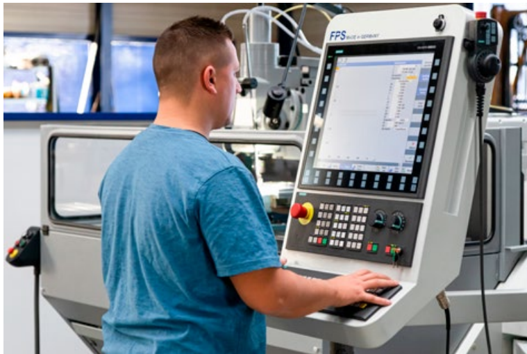
Die generalüberholte FP42-NC ist mit einer High-End-CNC Sinumerik 840D sl ausgestattet. An ihr programmieren Lehrlinge ab dem zweiten Lehrjahr diverse Werkstücke, die auch in der realen Fertigung eingesetzt werden.
