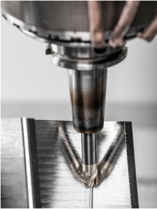
Der MD838 Supreme (z = 4 - 8) ist konisch ausgeführt und besitzt einen Wirkradius von 250 bis 1.000 mm.
