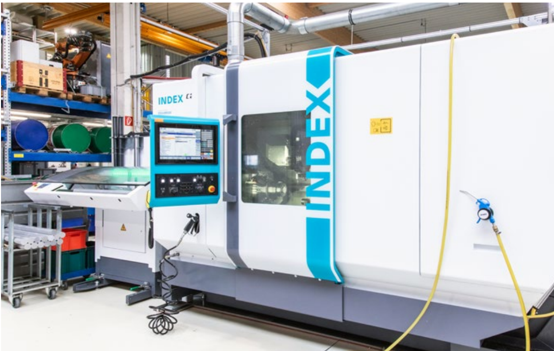
Der Produktionsdrehautomat Index C200 ist auf die hochproduktive Stangenbearbeitung komplexer Werkstücke ausgelegt.
