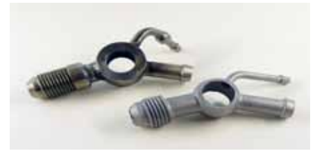
Im Hintergrund der originale Treibstoffsammler aus fünf Teilen bestehend. Im Vordergrund, der in einem Stück aus einer Titanlegierung mittels Lasersintering hergestellte Treibstoffsammler.
