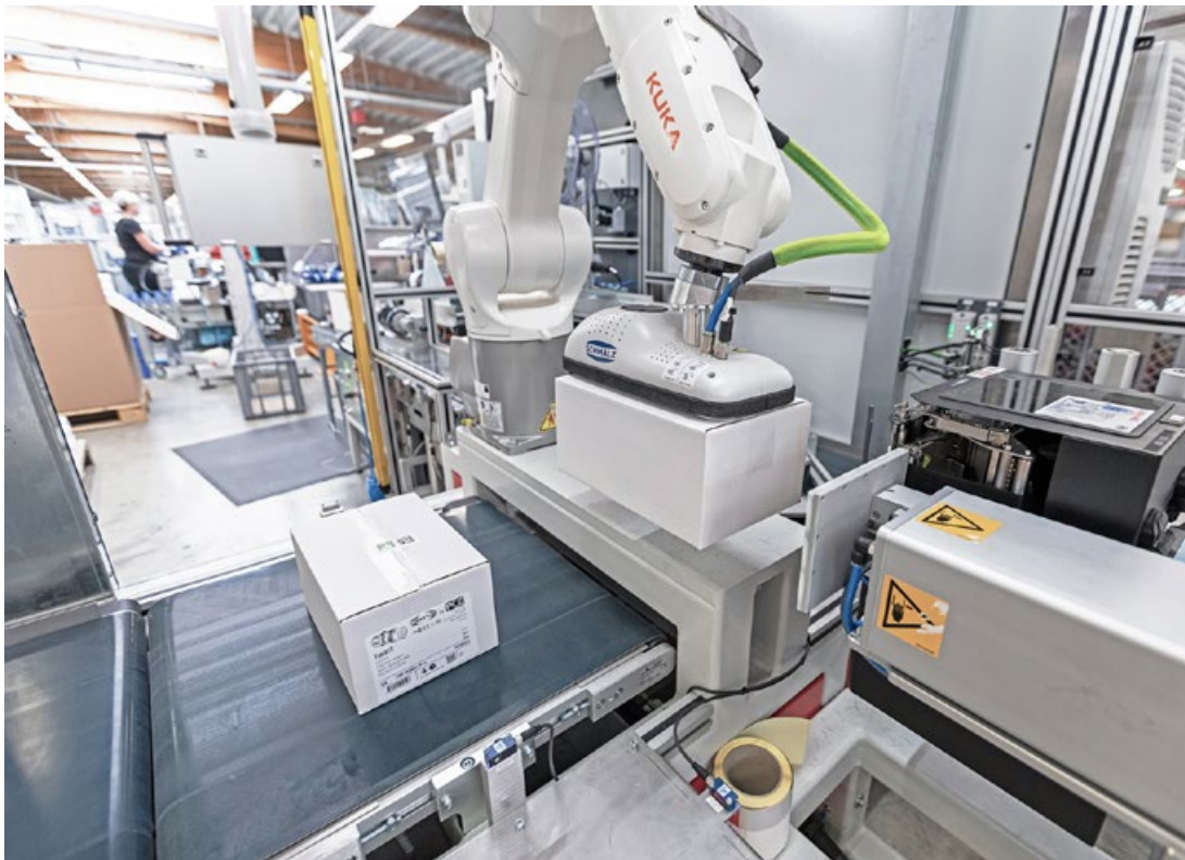
Der Greifer FXCB hält , das Etikettiergerät klebt. Das alles läuft automatisch.
