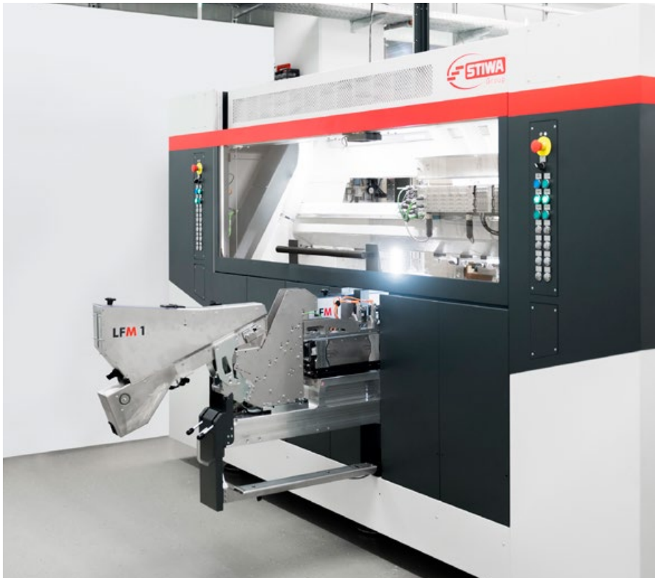
Die flexible Automationsplattform kommt je nach Auslegung und Bestückung mit einer Länge von 3 bis 4 Metern aus. (Bild: Stiwa)
