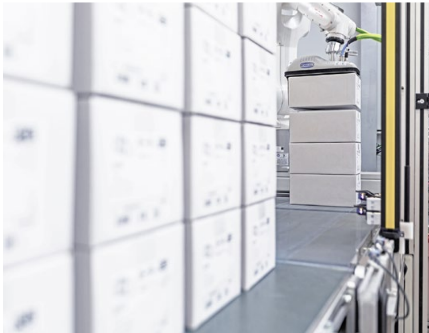
Kuka-Roboter und Flächengreifer FXCB bewegen rund 700.000 Schachteln pro Woche.
