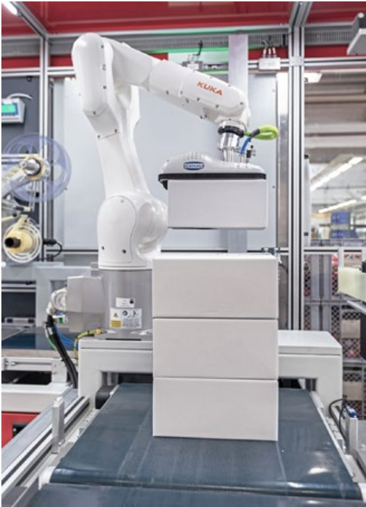
Das Handhabungssystem stapelt die Pakete auf dem Laufband.
